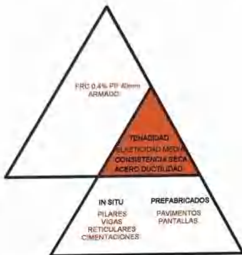
Figura 4.6. Propuestas de elementos constructivos de FRC.
