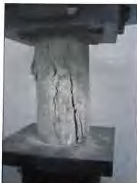
Figura 3.9. Rotura de probeta con la máquina de ensayos a compresión de carga estática del Laboratorio de Materiales de la ETSAM.
