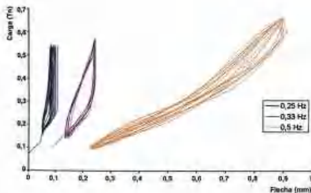
Figura 5.66. Gráficas carga-flecha de probetas ensayadas a flexión de carga dinámica a 4 puntos ECC PP 12 mm 70% 0/1 y frecuencias de 0,25 Hz, 0,33 Hz y 0,5 Hz (edad 28 días).
