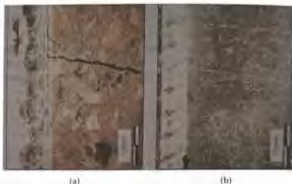
Figura 4.3. Imagen de la interfase acero-matriz cementicia y comportamiento en periodo plástico (a) Hormigón armado convencional (b) ECC armado. V. C. Li [4.2].
