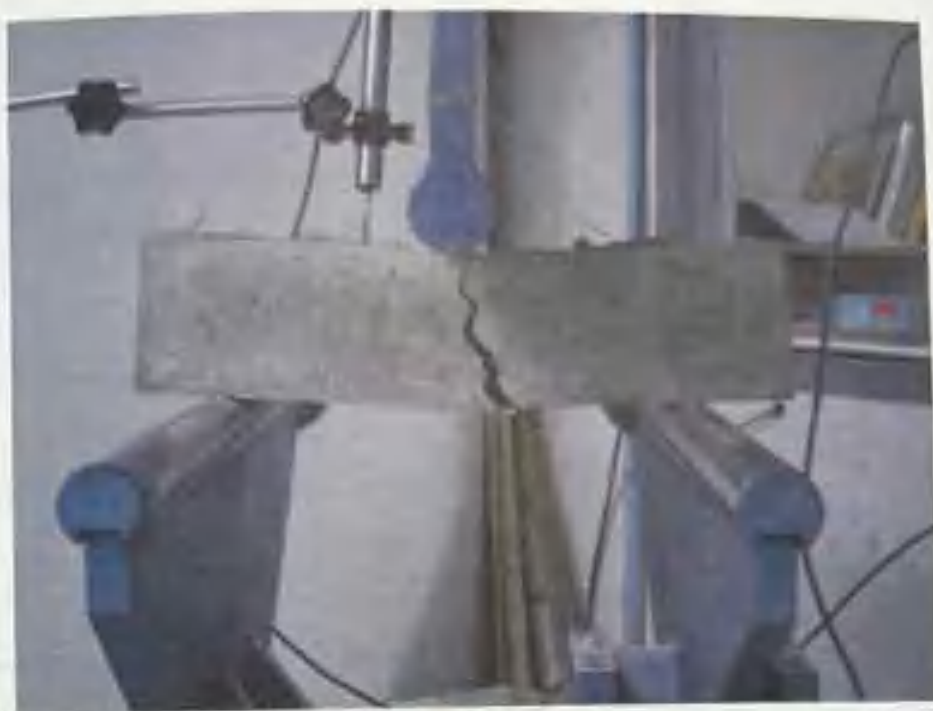
Figura 3.29. Imagen de ensayo finalizado de carga estática de flexión a 3 puntos de una probeta prismática de 40 x 10 x 10cm de FRC 0,2% PP. 40 mm.
