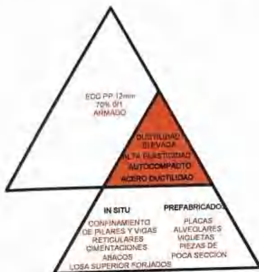
Figura 4.8. Propuestas de elementos constructivos de ECC.
