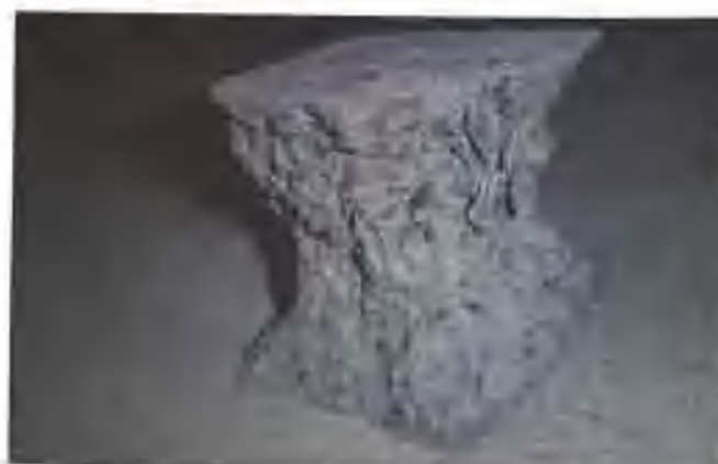
Figura 3.41. Probeta rota de SCC con la máquina de ensayos a compresión de carga estática del Laboratorio de Materiales de la ETSAM.
