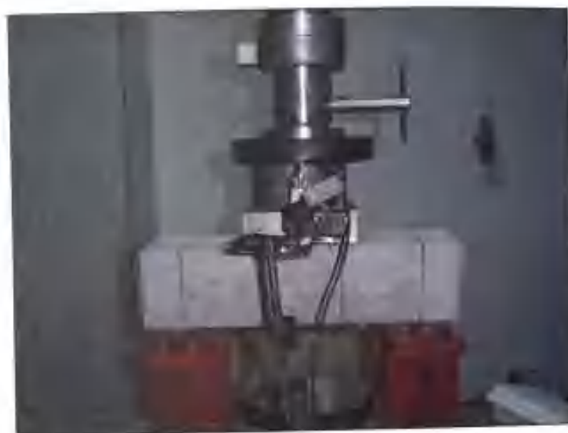
Figura 3.3. Máquina electromecánica de ensayos Codein a flexión de carga estática a 4 puntos del Laboratorio de Estructuras de la ETSAM.
